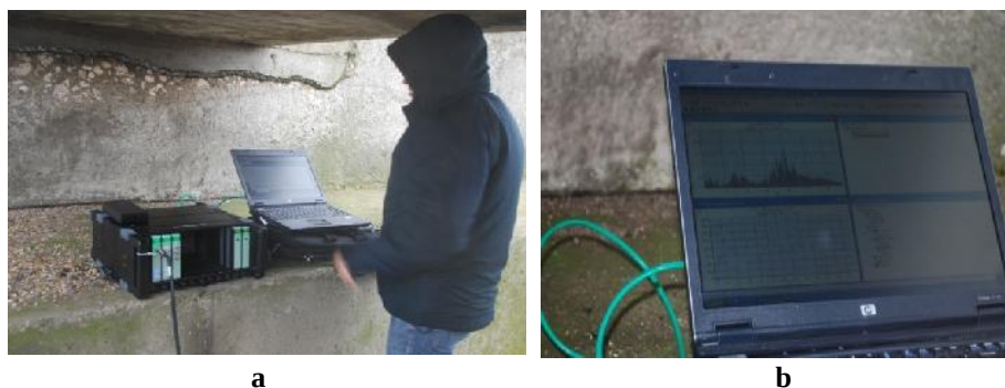
Fig. 5. 4 - Determinarea nivelului de vibrații din mediul marin în momentul de prelevare a probelor: a – privire generală asupra echipamentului utilizat; b – înregistrarea vibrațiilor pe ecranul laptop-ului
