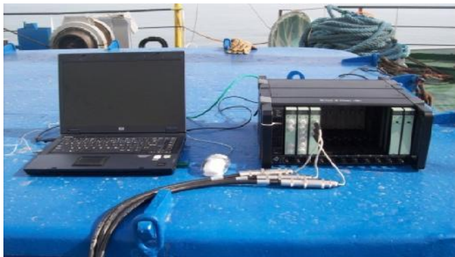
Fig. 5. 14 - Aparatura utilizată pentru măsurarea zgomotului de fond, emisiilor acustice ale navelor și emiteria sunetelor de către delfini
